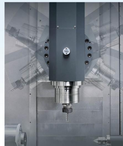
銑削 B 軸 \pm 110^\circ 旋轉角度 內藏式銑削主軸 12,000 rpm
